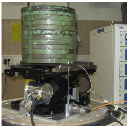
Prüfaufbau des aktiven Fahrersitzes auf dem Shaker
